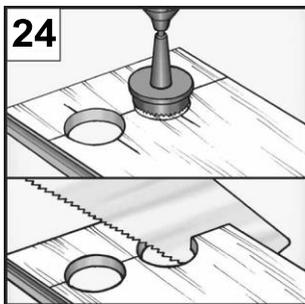
Для труб системы отопления следует избегать отверстий, диаметр которых на 3 см больше диаметра трубы. «Ответную деталь» следует вырезать, нанести на нее клей, установить и зафиксировать клином до полного высыхания клея. Затем закройте отверстие втулкой [23, 24, 25].
