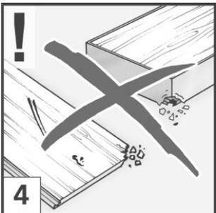
Проверьте панели на наличие дефектов и повреждений при хорошем освещении. Панели с видимыми дефектами, выходящими за пределы применяемых допусков и отклонений по высоте, размерам, гляncу и цвету, должны быть отбракованы и заменены бесплатно [4]. Для уже установленных или ранее обработанных панелей рекламация невозможна.
